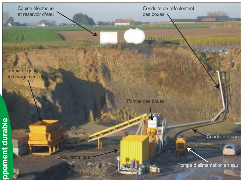
Figure 5 - Vue de l'installation de pompage de la découverte de la carrière du Tellier des Prés. Ce troisième site d'extraction des Carrières de la pierre bleue belge est exploité en partenariat avec Sagrex, qui traite la pierre non valorisable en pierre de taille.
