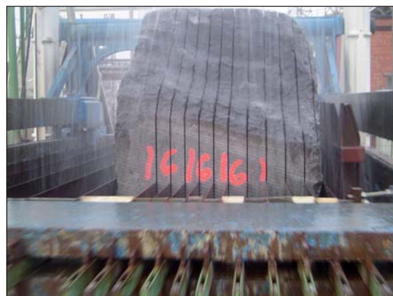
Figure 3 - L'eau nécessaire à la découpe de la pierre bleue belge circule en circuit fermé. Ici, la découpe d'un bloc de pierre bleue belge par une armure
